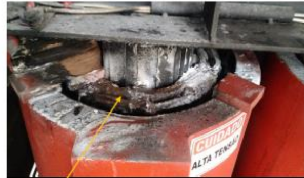
BOBINAS X3 E H3 QUEIMADAS. FALHA NO INICIO DO ENROLAMENTO (PROBABILIDADE DE SOBRE TENSÃO)
