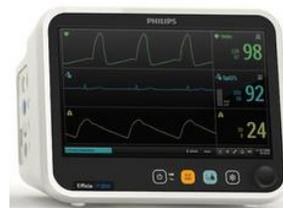
O monitor CM10 da Série Efficia é compacto, versátil e fácil de operar. Oferece medições de ECG, Resp, Oximetria de pulso, Pressão Não Invasiva, 2 canais de Temperatura, Análise de Arritmias e 2 canais de Pressão Invasiva.
