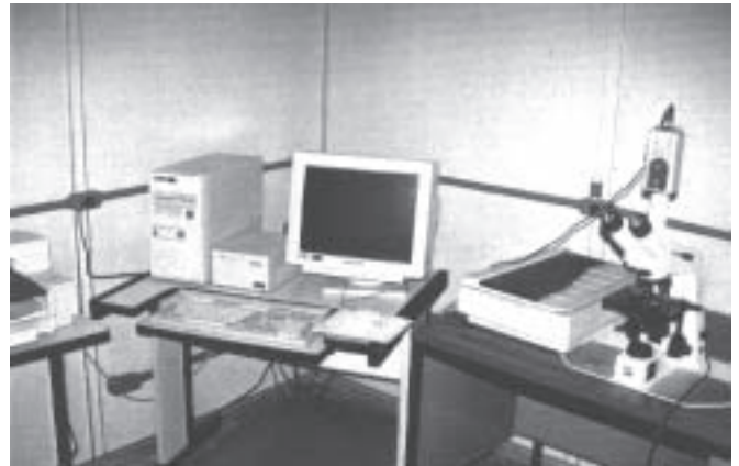
Fig. 2 – Microcomputador 486 DX2 66Mhz integrado ao microscópio modelo Axiolab Standard 20 através de uma câmera JVC colorida modelo TK 1180.
