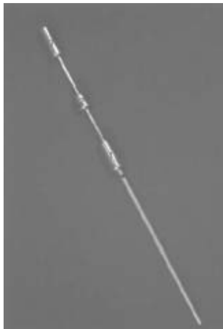
Fig. 2 – O mandril (3) introduzido na camisa (2) e ambos introduzidos na camisa (1)
