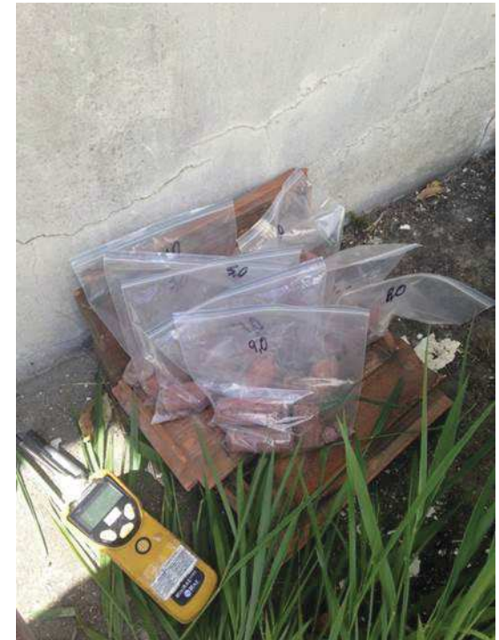
Fig 3: Amostras de solo para medição do vapor através do Detector de Fotoionização - PID
