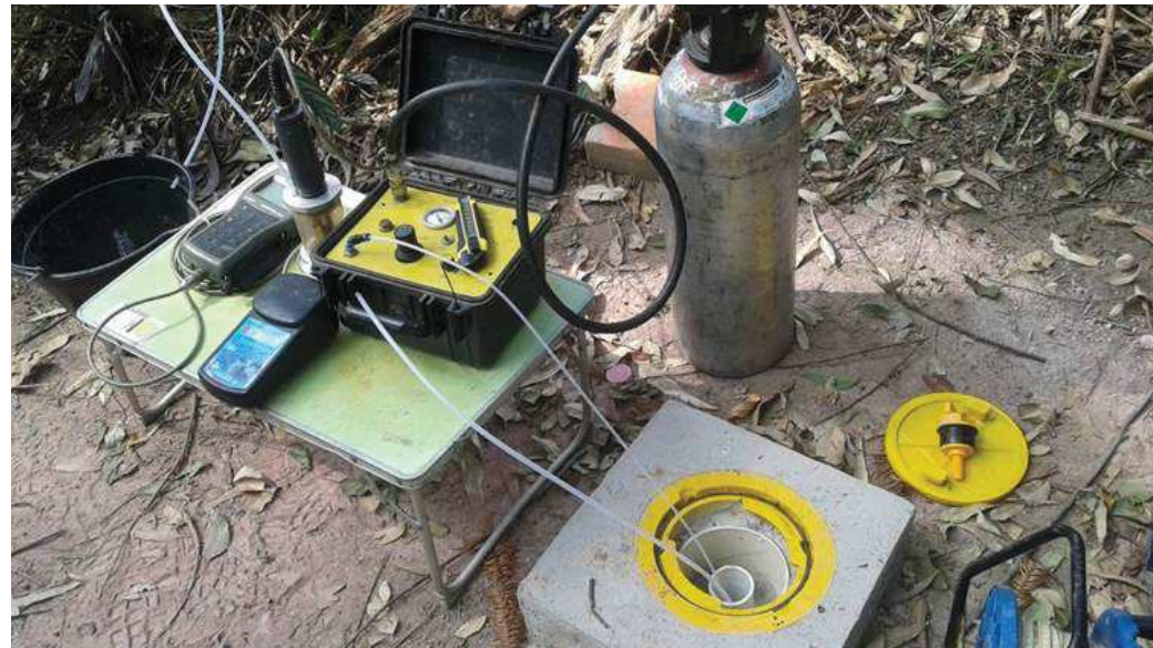
Fig 6: Material e equipamentos utilizados para a amostragem de água subterrânea por Low Flow. Em campo há a medição de nível de água, temperatura, condutividade elétrica, pH, oxigênio dissolvido e potencial redox.
