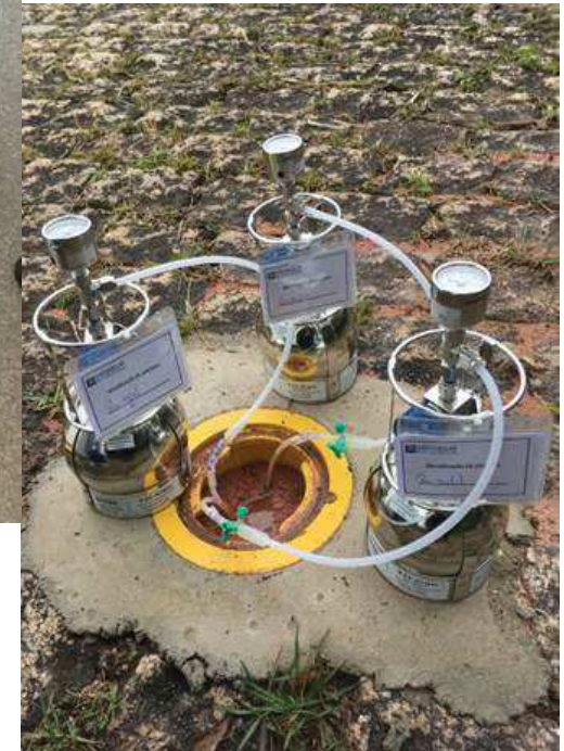
Fig 10: Coleta de amostras no poço triplo de vapor, através do método EPA TO15.
