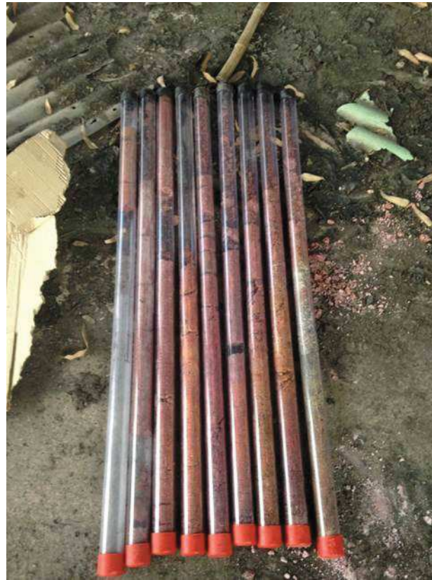
Fig 2: Amostras de solo coletadas através do Liner, futuro encaminhamento para análise.
