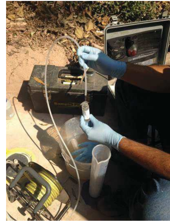
Fig 5: Coleta de amostra do poço de monitoramento de água subterrânea
