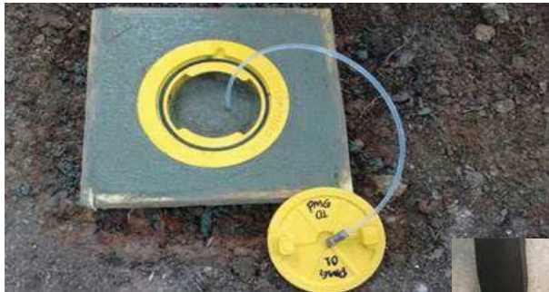
Fig 8: Poços de Vapor do solo instalados em área externa. Conjunto de poços de vapor no solo e contrapiso na Ed. Complexo Didático
